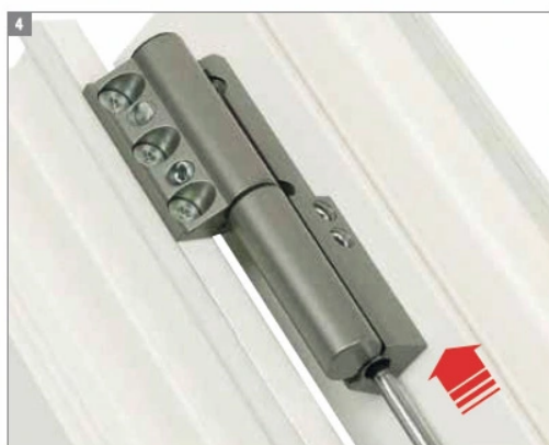
4. Regulacja pionowa w zakresie -1/+3 mm.
