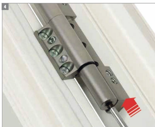
4. Regulacja pionowa w zakresie -1/+3 mm.
